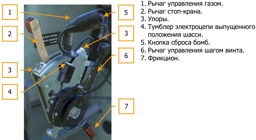
Рисунок 54: Система управления двигателем
